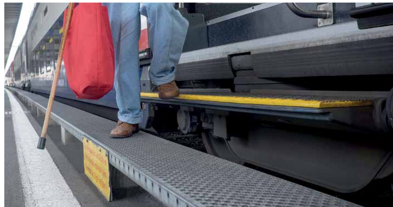
Beispiel eines Zustiegs, der nicht behindertengerecht ist: Perronkante und Einstiegshöhe der Fahrzeuge müssen aufeinander abgestimmt sein, damit ein autonomer Zustieg auch für Rollstuhlfahrende und Gehbehinderte möglich ist.
